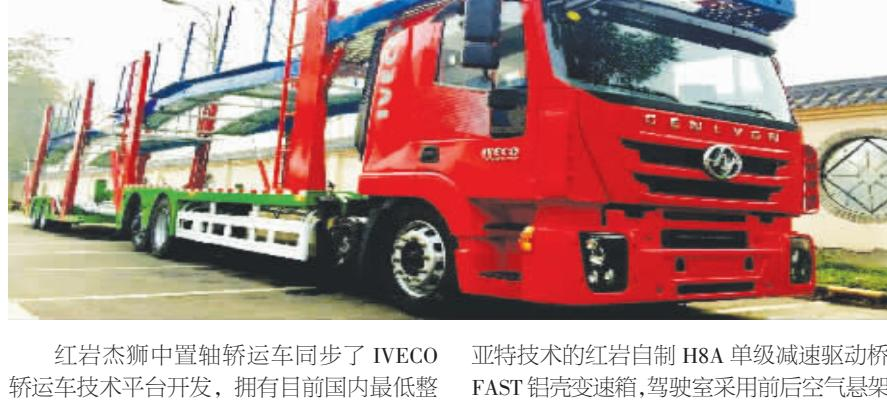
红岩杰狮中置轴轿运车同步了IVECO轿运车技术平台开发,拥有目前国内最低整车高度(整车高度仅为2670mm),车架上翼面离地高度:前悬架处826mm,后悬架处906mm,率先满足GB1589法律法规标准。
