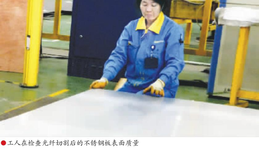
工人在检查光纤切割后的不锈钢板表面质量
