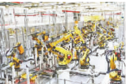
神龙成都工厂实现了100%焊接自动化。图为焊装车间的工业机器人。(神龙成都工厂供图)
