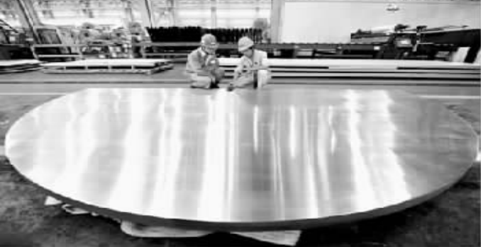
宝钢特钢技术人员与大明加工中心生产人员在检查核电蒸发器水室隔板表面加工质量。
