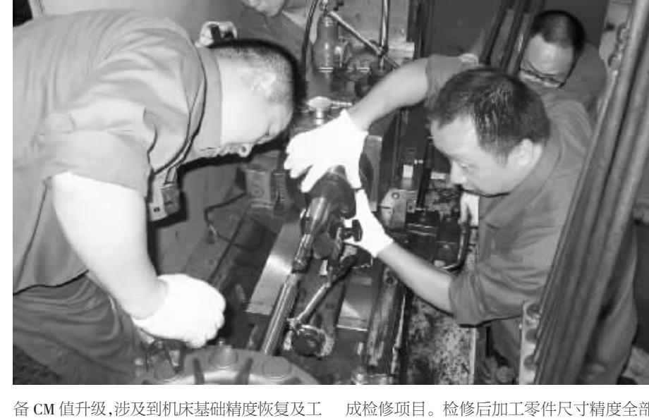
备CM值升级,涉及到机床基础精度恢复及工装夹具精度恢复,结构复杂,修理难度大。减速器车间因派出支援襄阳工厂设备搬迁8名保全工,在人力紧缺的情况下,得到装备科技人员大力支持,提前编制检修工艺、准备资料、备件,克服重重困难,于8月5日圆满完成检修项目。检修后加工零件尺寸精度全部满足工艺要求,检修合格率达100%。
