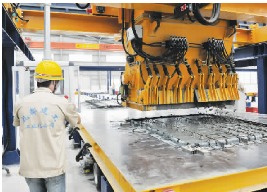
● 成都建工建筑工业化生产线上的布料机正在布料
