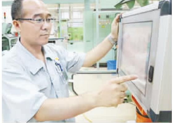
包装机组的工控机担负着设备运行、数据采集及物料呼叫等程序的运行,其稳定性是顺畅生产的关键所在。近日,河北白沙烟草有限责任公司石家庄卷烟厂多角度查找问题根源,排除设备故障,通过调整系统设置、网络服务、病毒查杀、清除系统垃圾等多种举措,实现了包装机组工控机运行效率的大幅提升。图为该厂卷接包车间技术员吴爱民正在调整工控机运行参数。
