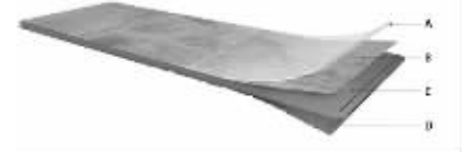
图4-4 NALFA认证的复合地板结构图
