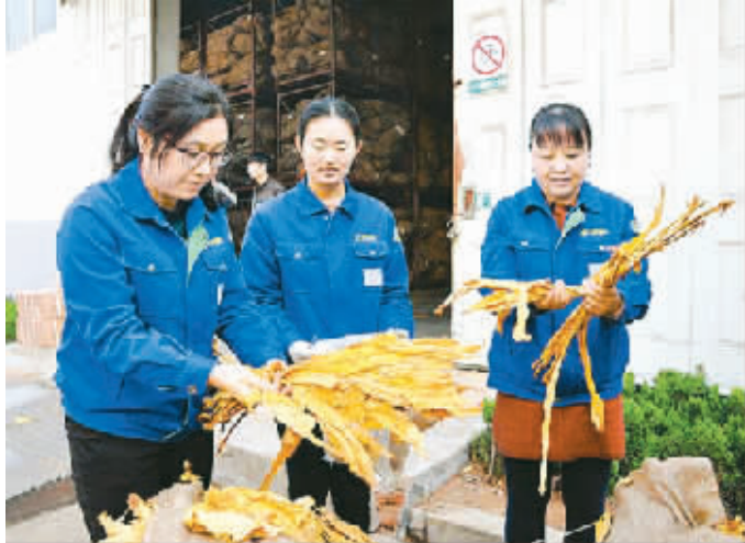
●化验员正在对入库前的原烟进行水分检测,检测合格后方可入库存放,这是复烤烟叶“入学”前的身份验证。
