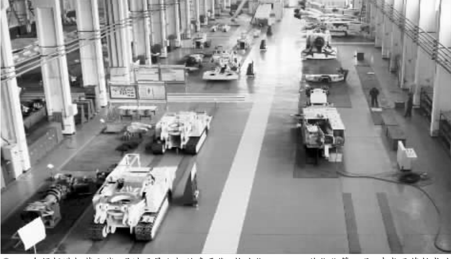
●301 车间掘进机装配线，通过开展人机效率平衡、物流优 ECRS 工艺优化等工具，建成了节拍式流水线化装配线，效率提升显著。
