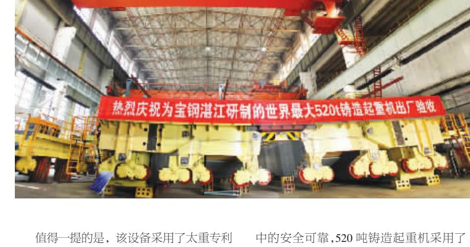
11月22日，太重承制的宝钢湛江钢铁项目炼钢工程主要设备——全球最大的520吨铸造起重机成功研发制造，并顺利通过了用户的出厂验收。作为全球最大的冶金铸造起重机，它的单钩起吊重量可以达到520吨，再次刷新了由太重自己保持的冶金铸造起重机世界纪录。
