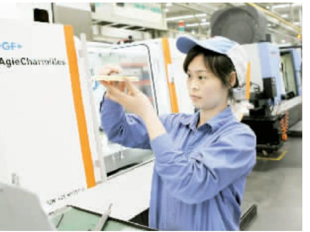
在许昌烟机公司,一个零件需要经过多道检验程序才能作为合格品入库。图为机加二分厂加工中心操作工詹艳芳对刚加工好的ZL26C机组产品零件进行测量。
