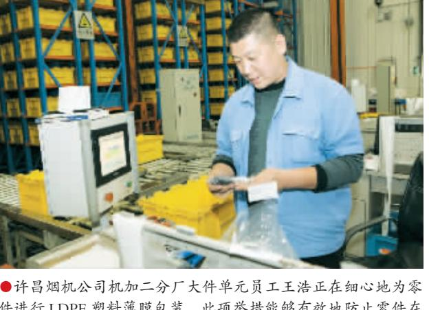
许昌烟机公司机加二分厂大件单元员工王浩正在细心地为零件进行LDPE塑料薄膜包装,此项举措能够有效地防止零件在转运过程中出现震动、磕伤。
