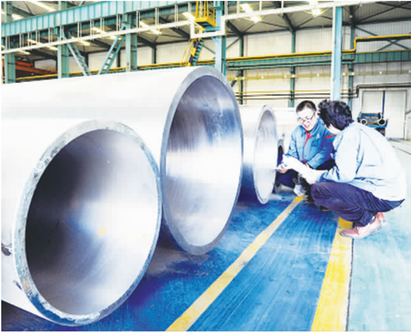
●采用 3.6 万吨垂直挤压机挤压成型的 P92 钢管
