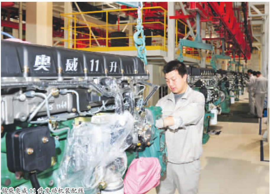
锡柴奥威 11 升发动机装配线
