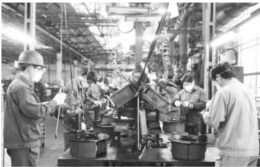
●东风德纳车桥十堰部件厂三车间总成班员工正在认真装配制动器。
