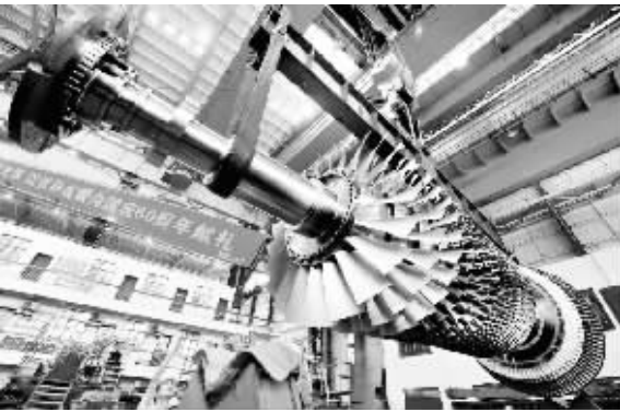
●东汽争分夺秒为客户赶制产品,图为加工完的燃机转子 刘岗摄
