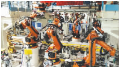
● 点焊工位对所有焊点都予以同样的风险控制。
