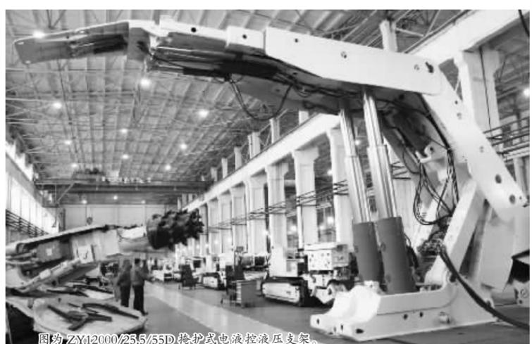
图为ZY12000/25.5/55D掩护式电液控液压支架。
