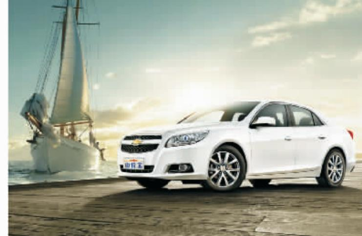
构按全球多地市场安全法规标准打造。全车73%的部位运用高强度钢材，在A柱、B柱、车顶等部位采用超高强度钢，最高屈服强度达1250Mpa，同等重量下强度超过普通
