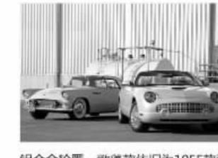
铝合金轮圈,敞篷款依旧为1955款那种可拆卸的黑色篷布车顶,车顶也可选装与车身同色的烤漆硬顶。
