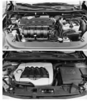
低了驾驶乐趣。比较而言，雷诺风朗搭载了一台2.0升16V发动机，输出功率为101千瓦（137马力），峰值扭矩达到191牛米。CVT无级变速器与发动机共同组成了兼具燃油经济性和驾驶乐趣的动力系统，提供了平顺和舒适的驾驶感受。从操控的角度来说，风朗的驾驶感觉更有乐趣一些，而轩逸则更偏向于柔和的一面。
