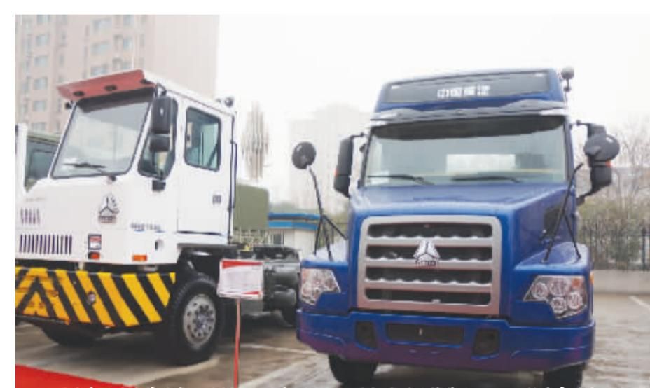
图为中重汽特种车公司新开发的专用于钢厂的超重型甩挂作业HOVA低速牵引车(左)和重载版威沃长头车(右)
