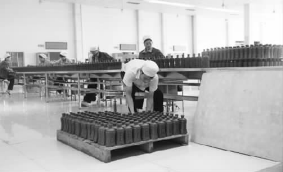
◎未安装自动升降平台时运码工需要反复弯腰操作。
