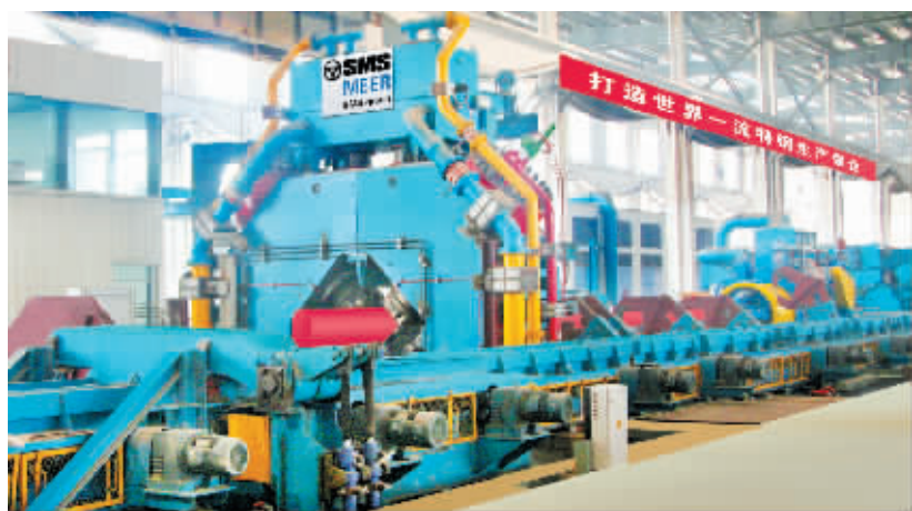
天工国际德国进口先进的 1300 吨精锻生产线。
