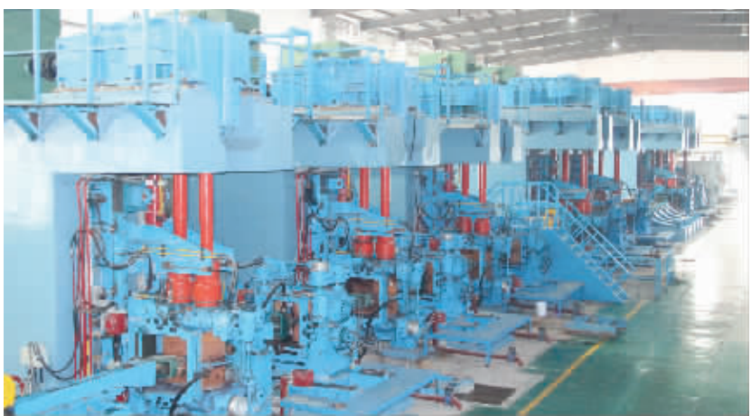
天工国际现代化棒线材生产线。
