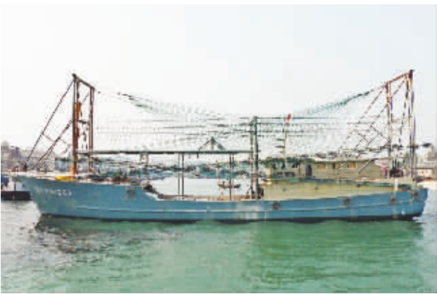
◎ 配装玉柴 YC6T450C 柴油机的钢质灯光围捕渔船
