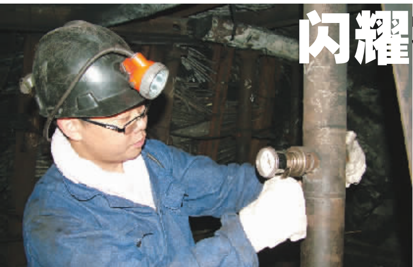
◎图为尹军洪正在全神贯注地检测单体初撑力。
