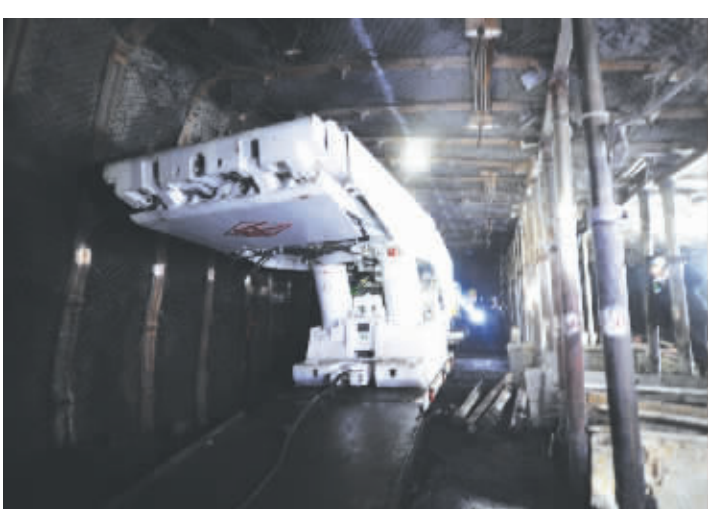
图为综采支架整体被推进齿轨卡轨车推进工作面。
