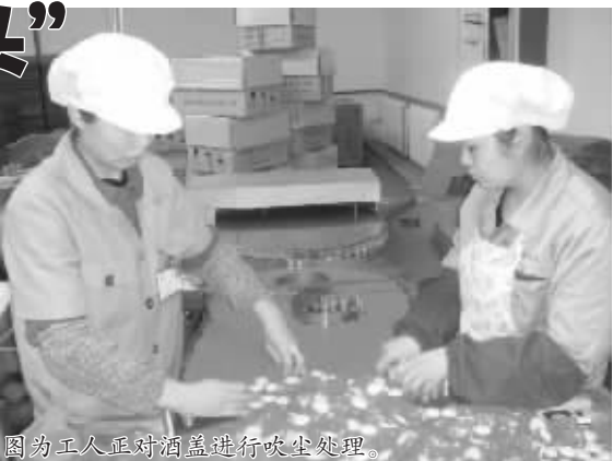
图为工人正对酒盖进行吹尘处理。
