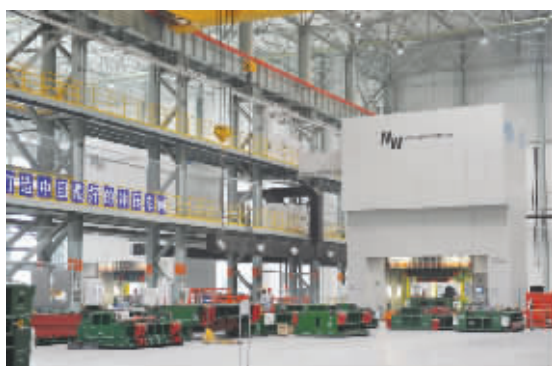
冲压车间拥有国内领先的三条8100吨压力机生产线。
