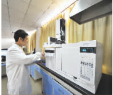
◆稻花香采用的是先进工艺设备,图为Agilent7000B GC-MSMS三重串联四级杆气质联用仪。
