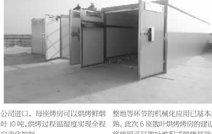
公司进口,每座烤房可以烘烤鲜烟叶10吨,烘烤过程温湿度实现全程自动化控制。
