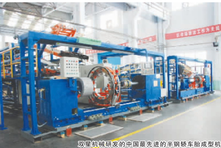
双星机械研发的中国最先进的半钢轿车胎成型机
