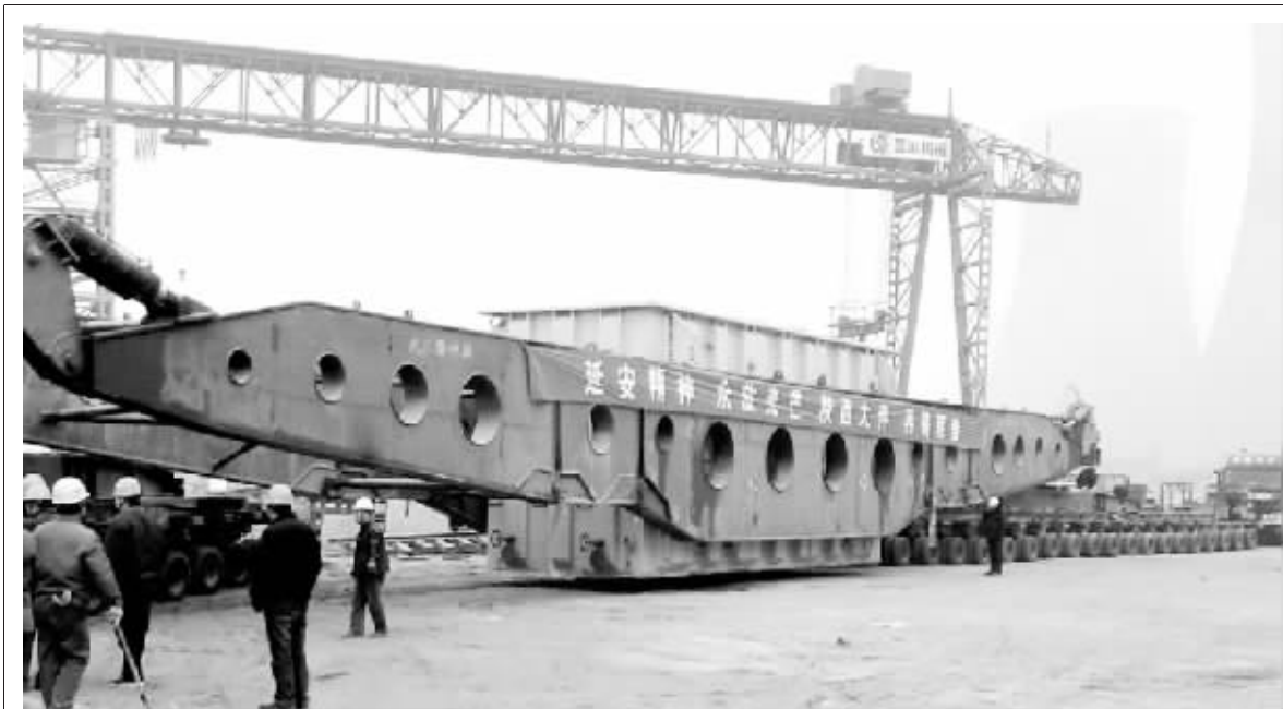
日前,由中国西电公司设计制造的国内首台三相一体750千伏变压器,已提前从西安运抵华能陕西秦电60万机组扩建现场待安装。这
