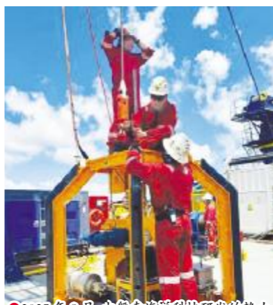
2025年8月，由警索海洋科技研发的静力触探系统矢量器-2型海床式CPT，在印尼进行骨干光纤通讯管项目前期调查。
