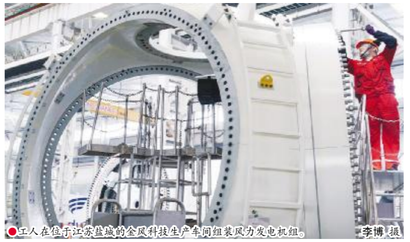
●工人在位于江苏盐城的全风科技生产车间组装风力发电机组。 李博 摄
