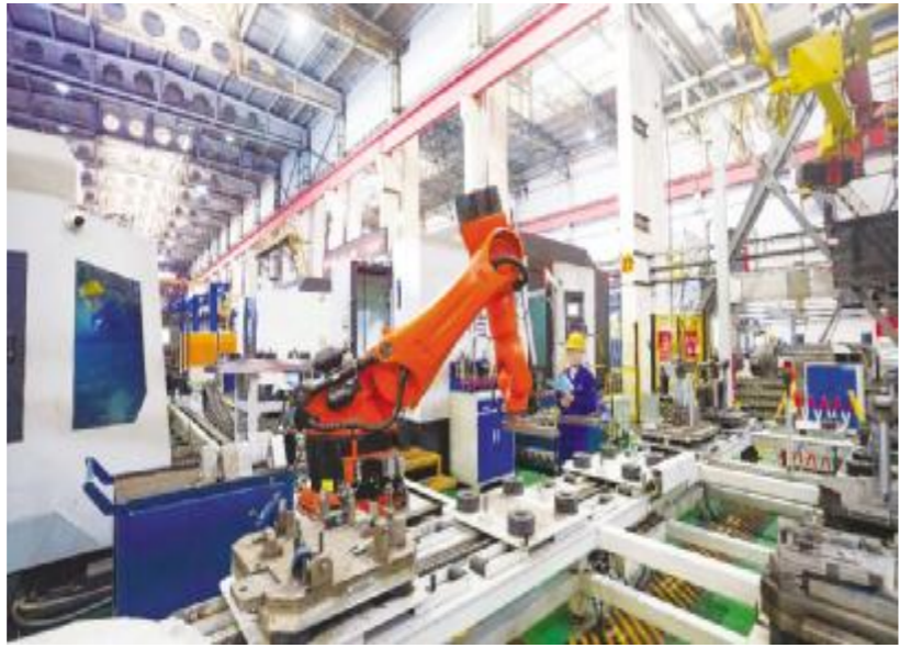
● 焊接机器人正在进行焊接作业。
