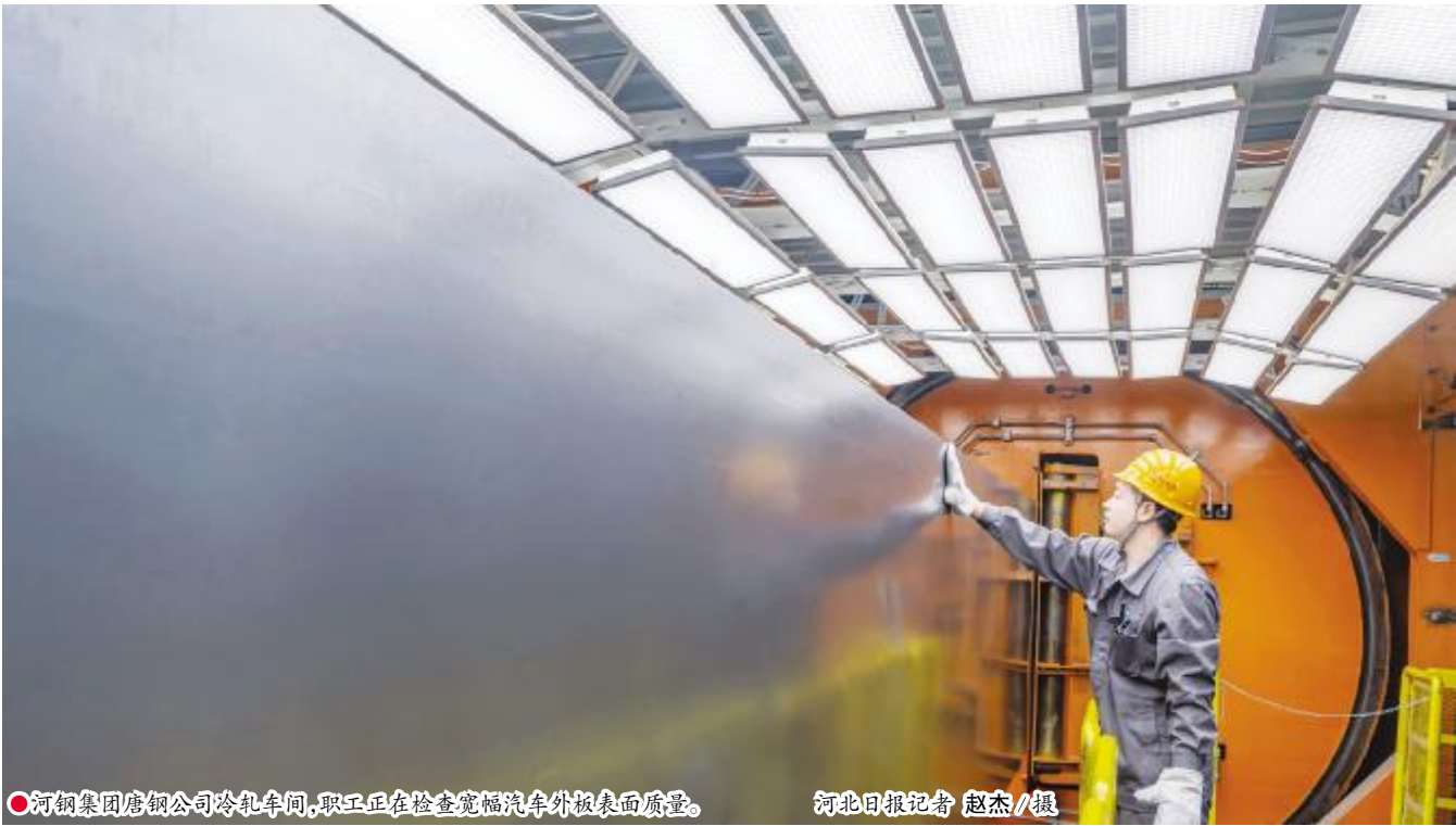
●河钢集团唐钢公司冷轧车间，职工正在检查宽幅汽车外板表面质量。
