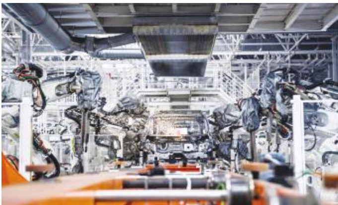
●在吉林长春中国第一汽车集团有限公司红旗繁荣工厂焊装车间内，焊装机器人在生产线上焊接车身。 新华社记者 颜麟麟 摄
