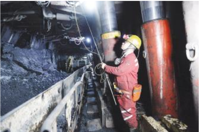
● 马道头煤业公司通风区瓦检员正在综采工作面使用瓦检仪、探杖等专仪器开展瓦检工作。
