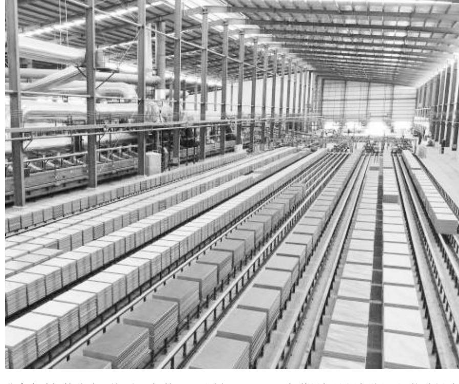
业全自动智能分选系统，人工智能(AI)识别瓷砖缺陷正确率达99.5%，处理速度达2000件/小时，较人工检测提升了40倍，用工成本减少25%。
