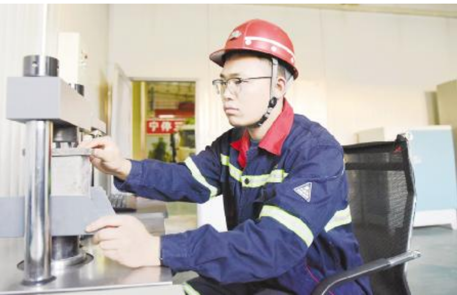
● 博选公司技术人员对煤矸石混凝土试块进行压力测试。
