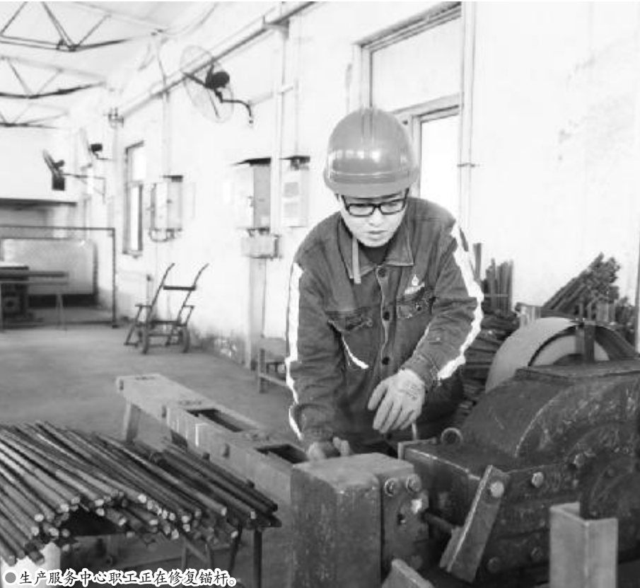
●生产服务中心职工正在修复锚杆。
