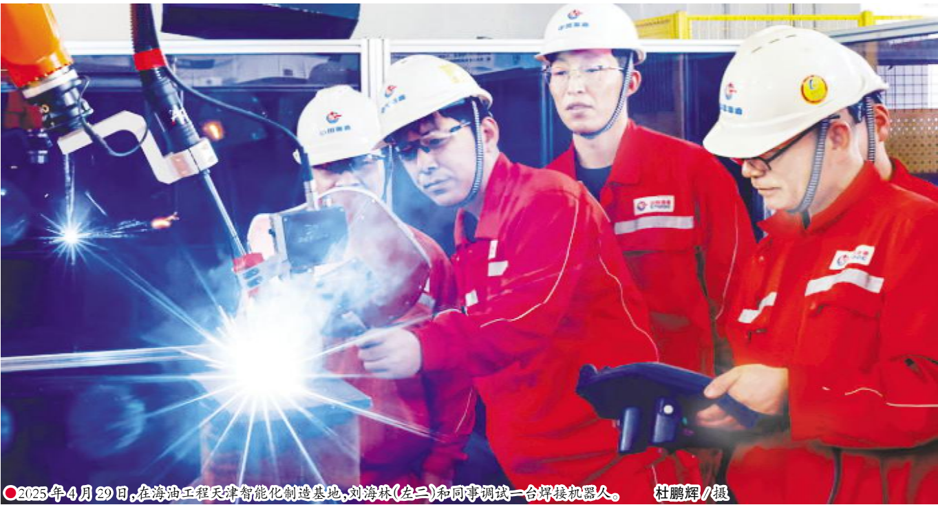
●2025 年 4 月 29 日,在海油工程天津智能化制造基地,刘海林(左二)和同事调试一台焊接机器人。 杜鹏辉 / 摄
