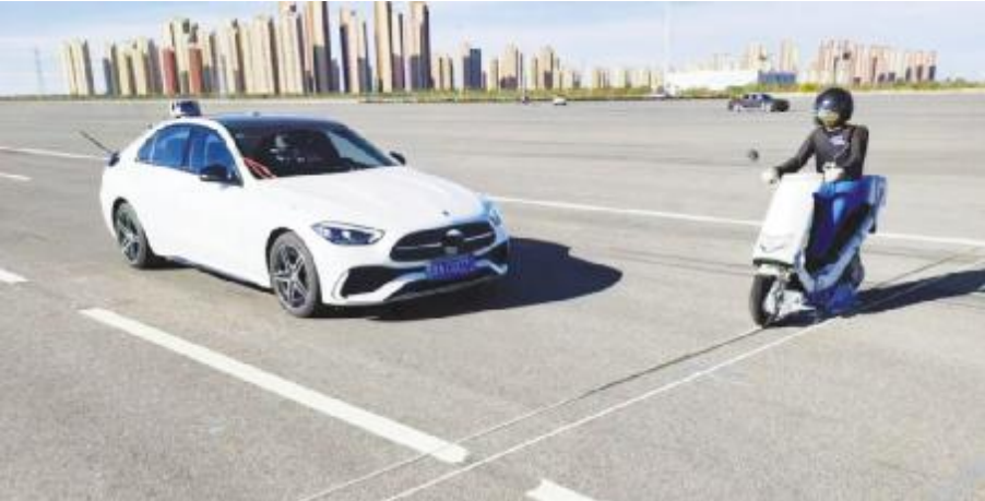
●在天津（西青）国家级车联网先导区的封闭测试场，智能网联汽车测试员检测一辆智能网联汽车的自动紧急制动系统功能。
