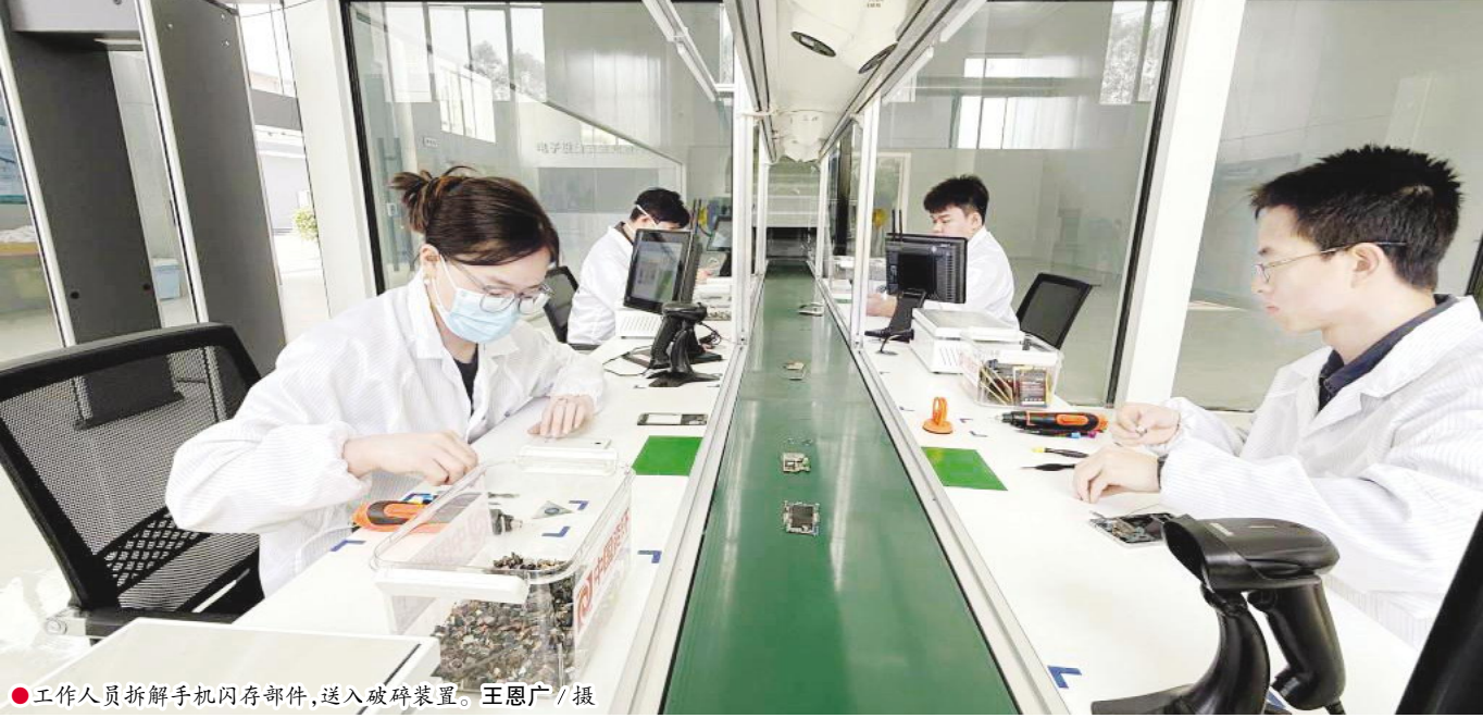
● 工作人员拆解手机闪存部件,送入破碎装置。王恩广/摄
