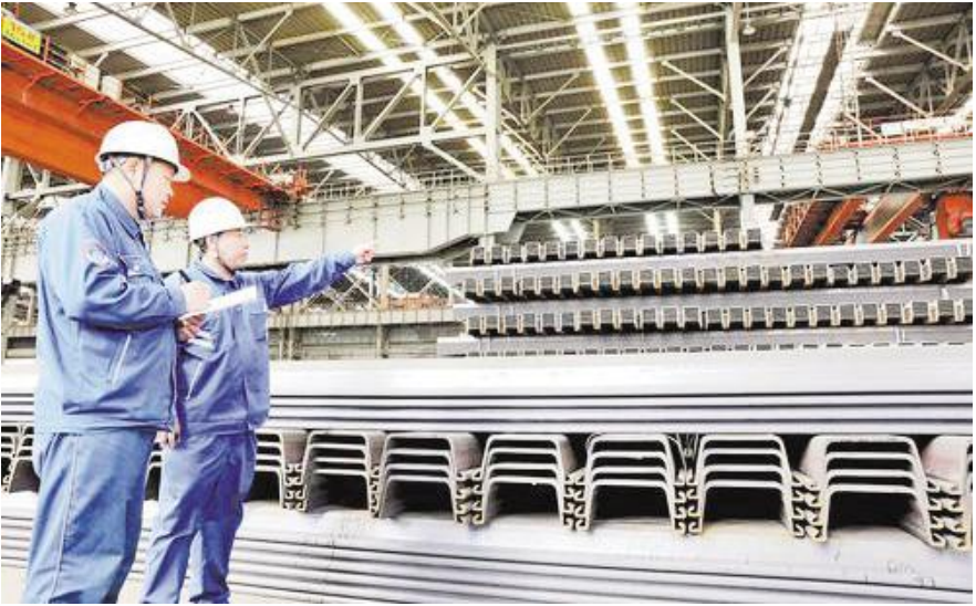
●热轧钢板桩车间成品库，工作人员对成品进行抽检。
