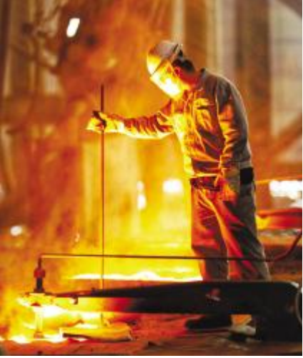
●工人正在检查打包内钢水剩余量。
