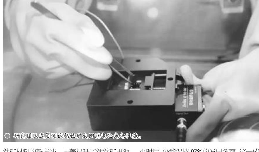
○ 研究团队成员测试钙钛矿太阳能电池光电性能。
