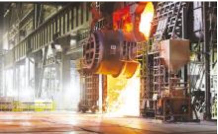
●西昌钢钒炼钢厂冶炼区兑铁作业。
