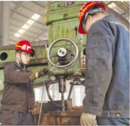
● 朝源煤矿龚晓茜(左)和工友在机床上加工综掘机配件。
